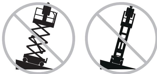
Não dependa do alarme de inclinação como um indicador de nível. O alarme de inclinação soa no chassi e na plataforma quando a máquina está em um declive acentuado.
